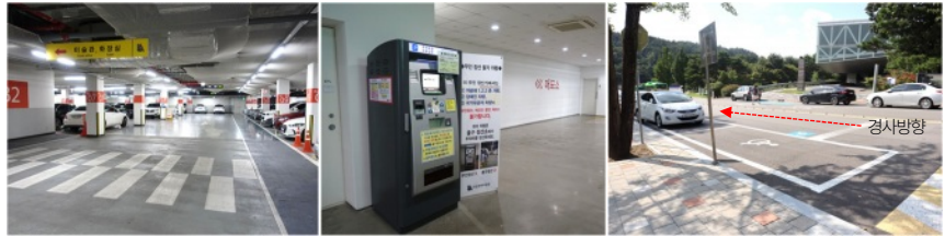
노면 포장색을 구분하여 보행동선 확보 휠체어이용자에 높은 주차정산기 경사로 양변에 평행 주차구역 배치
